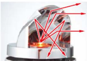
LED回転灯には新開発のLED回転灯専用設計のリフレクションシステムを採用しています。LEDは従来の電球よりも光の拡散性能が劣ってしましますが、専用設計の反射板の採用により、この問題を克服し、電球回転灯に劣らない光の拡散性能を確保しました。
