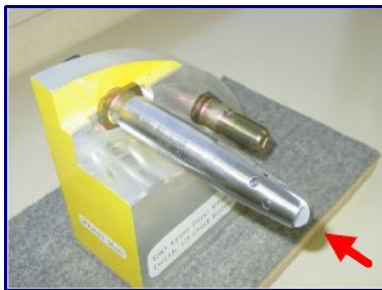
センターガイドを上下対角に2本挿入します
