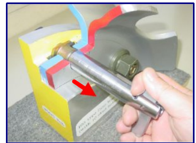
取外しハンドルを持って抜き取り、残りのナットを締めます
