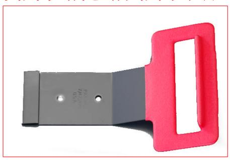
窓ガラスとドアの間より、モールを簡単に取外せます。 クリップを触らずキレイに取れるのでモールの再利用が可能です。 先端幅...57mm 厚み...1.2mm 先端引っ掛け部厚み...5mm スチール製 開口入口内厚...2.5mm
