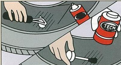
タイヤ内面傷口中心にバッファー液「ラブ・オ・マチックNo.704-A」を吹きつけ、インナーライナー表面に附着している汚れ、シリコン、グラファイト粉等をスクレーパー (No.933) で完全にとり除ききれいなウエスでゴムかすをすくいとり良く乾かす。パッチをはる部分にケミカルセメント (#760) をうすく均一に塗り乾燥させます。
