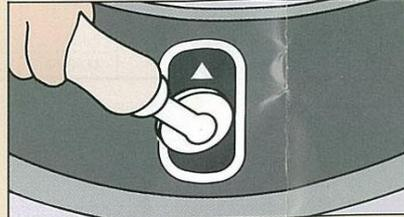
ケミカルセメントが完全に乾いたらセンテックラジアルパッチをローラーで圧着します。この時パッチの矢印を必ずビード方向に向けて下さい。
