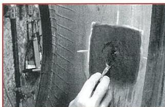
**6** スパイラルツール(#915)にケミカルセメント(#760)をたっぷり付け右回しで、傷口にケミカルセメントを押し込んで下さい。パッチ面にケミカルセメント(#760)を、薄くむらなく塗りよく乾燥させて下さい。
