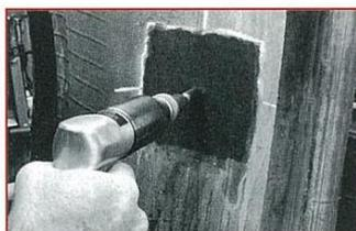
**4** TECHエアドリル(S-1035)にカーバイドカッターをセットし、傷の角度に沿って内側から右回転でスチールコードの処理を行って下さい。この作業を最低4回繰り返し、同様に外側からも同じ作業を行って下さい。\*カーバイドカッターは1200回転以下のドリルで使用してください。
