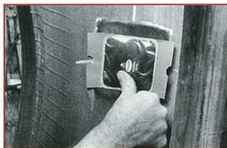
**8** 指でパッチ中心部分から外側へエア-を押し出し保護用ポリビニールを完全に剥しステッチャーローラー(#936)で良く圧着して下さい。
