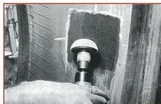
**3** TECH低速エア-バッファー(#S-1036)にラバーフォグ(S-2030)セットし外郭線の内側をバフして下さい。\*作業の際は、必ず目を保護する為にゴーグルをおかけください。バフ後に出たゴミかすをTECHバキューム(S-999)で吸い取って下さい。
