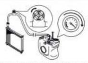
負圧計の針が約-0.09MPsに達し、停止したら切替スイッチを右方向 (CHARGE側)に回転させ、タンク内の冷却水をラジェータ内に注入 します。負圧計の針がゼロに戻った時点で注入完了です。
