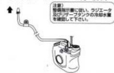
コーンブラグと注入ホースをタンクより高い位置まで上げ、 ホース内の残留冷却水をタンクへ戻します。
