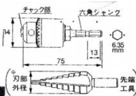
インパクトドライバーでの使用の場合、衝撃により軸部（チャックアダプター）が破損することがありますので充分ご注意ください。
