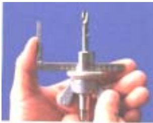
穴径調整は蝶ネジを回すだけで簡単に行えます。
