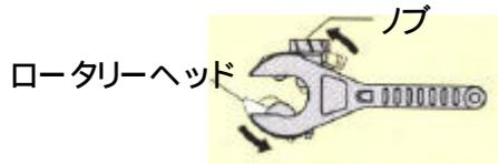
ロータリーヘッドを回し、本体とロータリーヘッドの開口部を合わせます。
