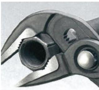
口幅は19段階に細かく調整でき、最大42mm(1 5/8")までのボルトやナットを掴むことができます。
