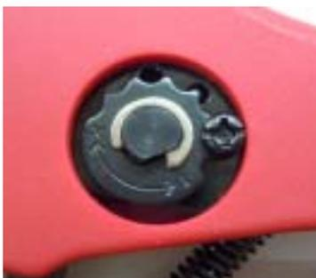
ネジを外し、ギアを回すと圧着荷重の調整が出来ます。
