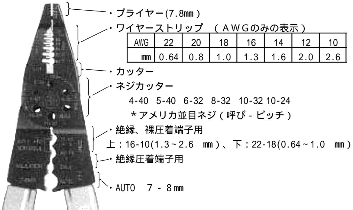
ネジカッター...各穴のサイズに合ったネジをねじ込み、ハンドルを握りネジを切断します。
