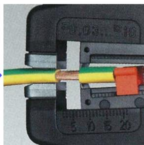
刃が自動的に最適な深さまで切り込み、皮を剥きます。
