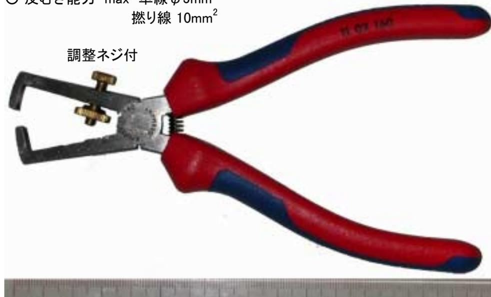
上下の刃の間にできた隙間で線を傷つけずに被覆だけむきとります。
