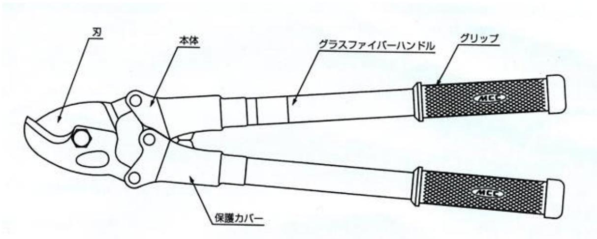
切断能力... 22mm(銅より線・アルミ線・それらからなるケーブル用)
