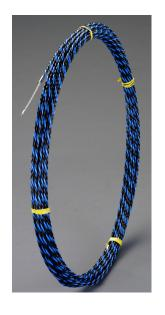
テープサイズ... 5.4mm×30m テープ材質...ポリエステル 使用荷重...784N(80kgf) スチール製リードヘッド付 スリムヘッド( 4.5mm)で狭いすき間も滑らかに 通線できます。 重量...500g
