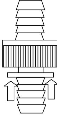
接続状態の時、オス側のリングを、メス側に押し込み、メス側に押し込むと分離します。
