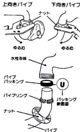
①ハンドルをしめて水をとめてからレンチ等でパイプのナットをはずし、パイプを抜きとります。
