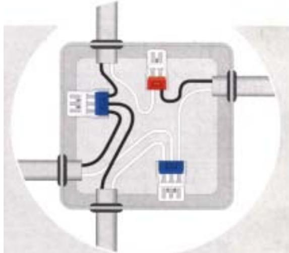
**クイックロックは、屋内配線用差込形電線コネクターで電線を差込むことで接続されます。**
