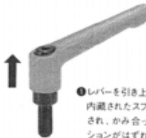
①レバーを引上げてください。内蔵されたスプリングが圧縮され、かみ合っていたセレーションがはずれます。
