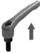
レバーを引き上げると、かみ合っていたレバーとねじ部のセレーションが外れます。
