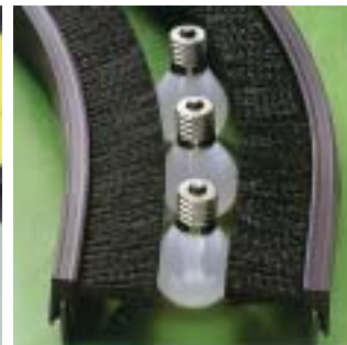
レールに取付けた搬送ガイド
