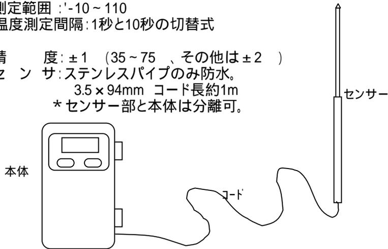
寸法・重量：66(W)×107(H)×20(D)mm 約130g(電池含む)
