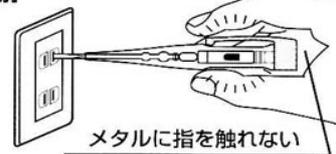
コンセントの穴にテスターの先端を差し込み、LEDの点灯反応のある側がHOT側で反応ない側がアース側です。この時メタルには触れないで下さい。
