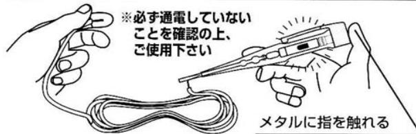
テスターの先端を導通間と思われる一方に接触させ他方を指で触れます。導通であればLEDランプが点灯します。
