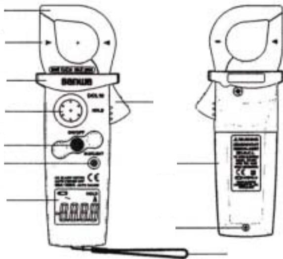
トランスコア(CT) : 被測定導体をクランプして、電流を検知するトランスの鉄心部分
