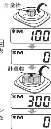
計量皿から容器を取ると記憶した重さ呼び出し、「300」→「100」→「200」の順に表示部に表示します。200gを表示した後、「M」表示は消え、オートゼロモード初期状態に戻ります。
