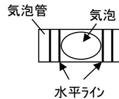
各レベルの気泡管の水平ライン内に気泡が入る場合、配管の勾配がレベルの勾配となります。
