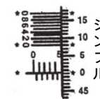
図 B READING 5.000 MM
