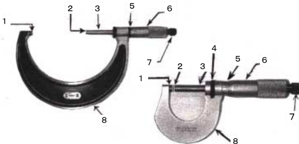
1. アンビル 2. 計測面 3. スピンドル 4. ロックナット 5. スリーブ
