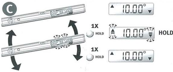
C. HOLDボタンを1回押すと、計測した傾斜角度の表示を保持します。
