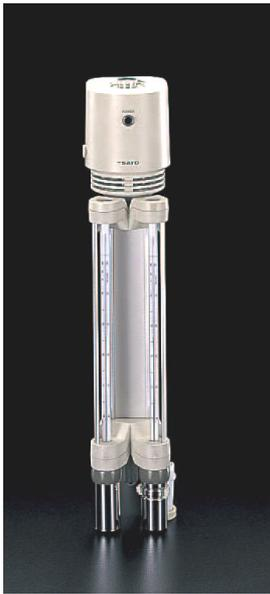
信頼性のある気象庁検定付機種も揃え、安定した湿度の標準として高い信頼を得ていますが、更に操作性・精度の向上を図るため改良を加えたのが、アスマン式乾湿計です。湿球部には特殊湿球布を採用し、ガーゼに比較し交換が簡単な上、本体に給水瓶を標準装備して長時間にわたり、水の補給を不要にしました。
