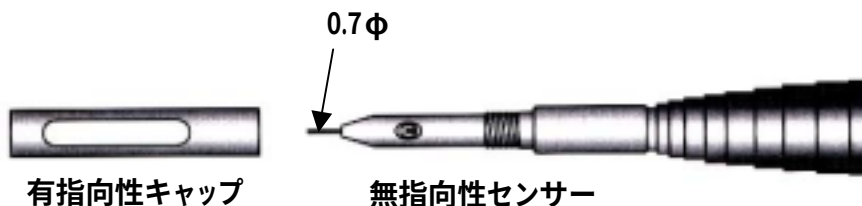
[風速・温度プローブ先端の構造]
