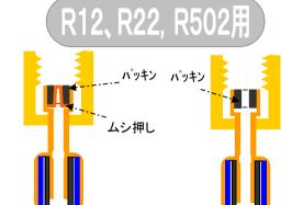
チャージホース断面 ホースの接続口は片方側にムシ押しが入っています。 バルブコアを内蔵したサービスポートにねじ込んでください。 ムシ押しのない方はバルブコアを内蔵しないサービスポート にねじ込みます。
