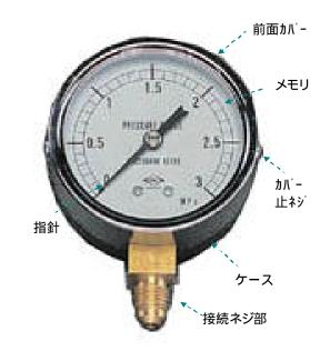
ブルドン管とは断面が楕円形の管を円形状に曲げて一端を固定し、他端をとじたものです。 保安用や工程管理用などに広く用いられています。
