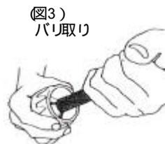
バリ取り 切断した銅管はフレア作業を行う前に
