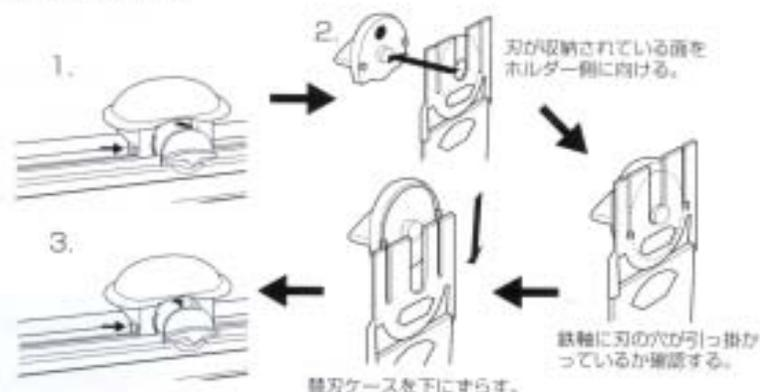
⚠ 刃の交換の際に直接刃先に触れないで下さい。
