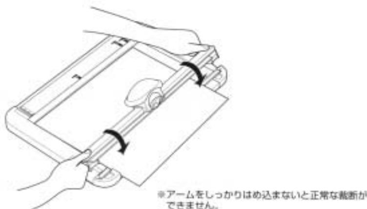
2. ご希望の裁断サイズに合わせて、紙合せ定規の右端を、紙台盤に表示されている定形サイズガイドや寸法目盛りにセットします。
