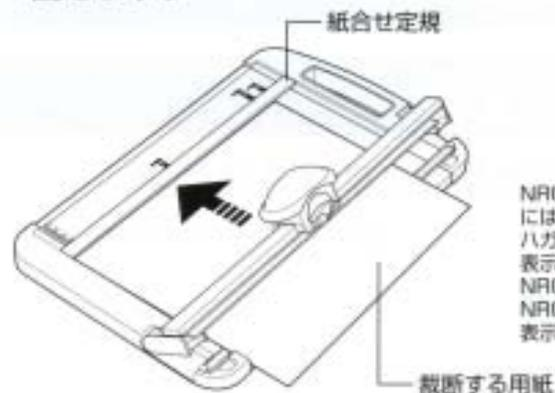
NRC-N2A3の場合、定形サイズガイドにはA3・B4・A4・B5・A5・B6ハガキ・写真（Lサイズ）の8種類の表示をしています。
