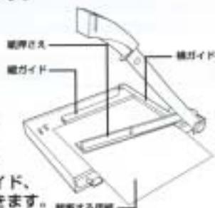
3. テーブルと紙押さえにすき間ができる位置で固定されていることを確認し、裁断する用紙をズレないように縦ガイド、横ガイドに合わせて置きます。
