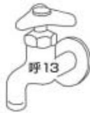
内径 15mm の水道ホースが確実に取り付けられる丸蛇口でお使い頂けます。水道ホースを蛇口に差し込み、付属のホースバンドで固定します。
