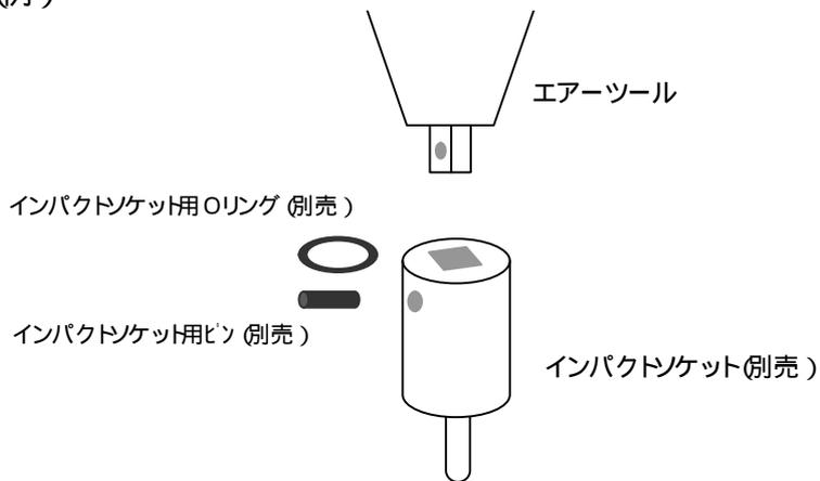
必ずインパクトソケット用ピン、Oリングを併用してください。
