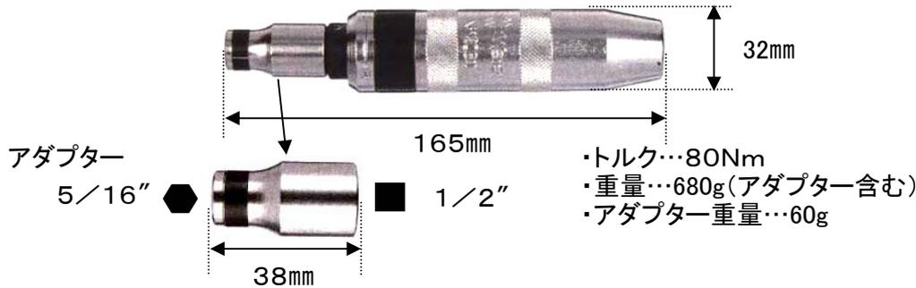
インパクトスクリュードライバーはハンマーでドライバーの上部を叩くと同時に締める場合は右にわずかに動き、緩める場合はわずかに左に回ります。
