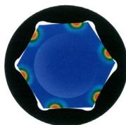
ボルトの角に当たるのをわずかに避けて、辺にあたる面積を増す事により、滑るのを防ぎ、トルクの伝達を増大します。
