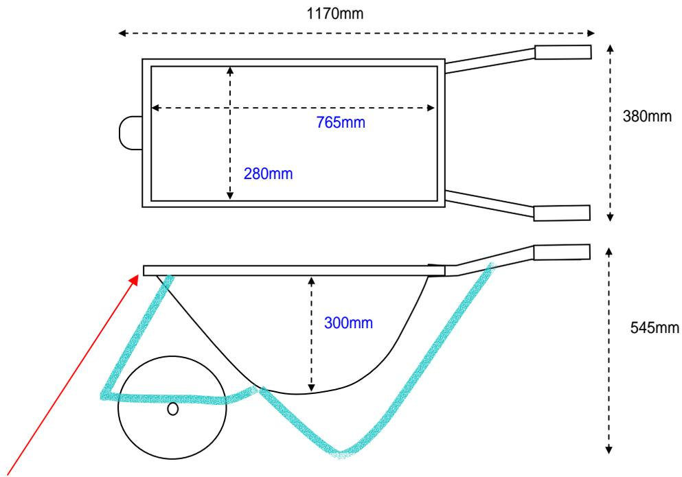
土砂を入れるコンテナ部分の鉄板の厚みは0.8mm
