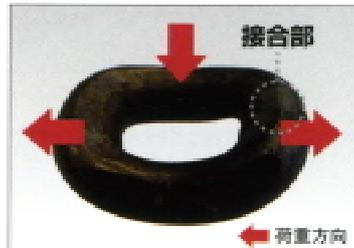
一度曲げたものを、反対方向に曲げなおします。この時も亀裂がないか確かめます。さらに、溶接部を引張り、変形させます。この時点でも、亀裂がないか確かめます。このテストは、RUD社独自のものです。
