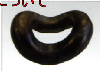
横曲げテストを行います。溶接部に亀裂がないか確かめます。また、この角度までまげるのにどれくらいの力が必要か、同様に計測します。硬すぎても亀裂が発生し、やわらかすぎると規定の耐力ができません。
