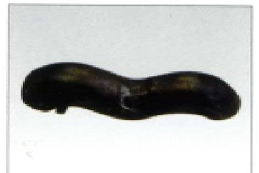
さらに、上から押さえます。この時も、亀裂がないか確かめます。これらのテストをクリアしたロットのチェーンのみ、熱処理工程へ移動するのです。
