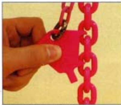
リンクの外伸びを測定します。
