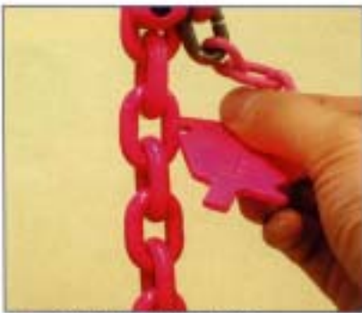
チェーンの線径を測定します。
