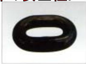
溶接を終えたばかりのリンク。
