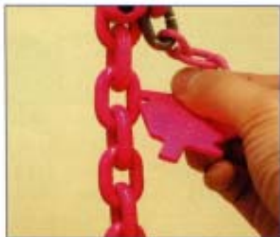
チェーンの線径を測定します。
