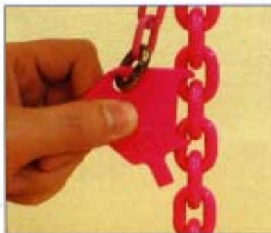
リンクの外伸びを測定します。
