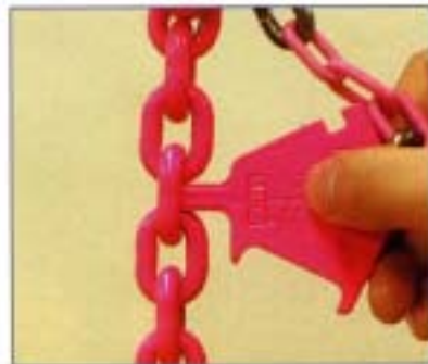
リンク間の磨耗や伸びを測定します。
