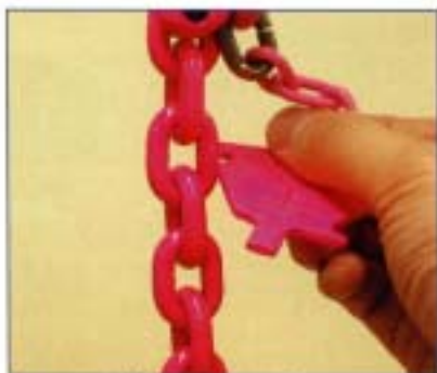
チェーンの線径を測定します。
