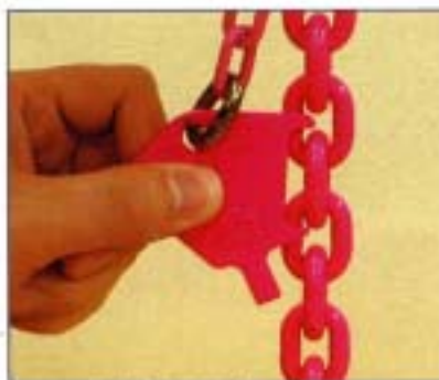
リンクの外伸びを測定します。
