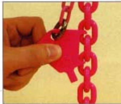
リンクの外伸びを測定します。
