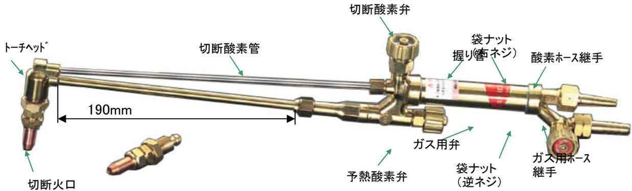
○ 切断用は高圧酸素を導く酸素管が儲けられています。火口の構造は同心型となっており、先端中央に酸素噴出用の小穴と、その周辺には環状に予熱用の穴があります。
